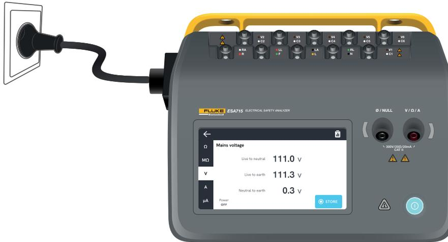
Abbildung 14: Testaufbau für die Netzspannungsmessung
