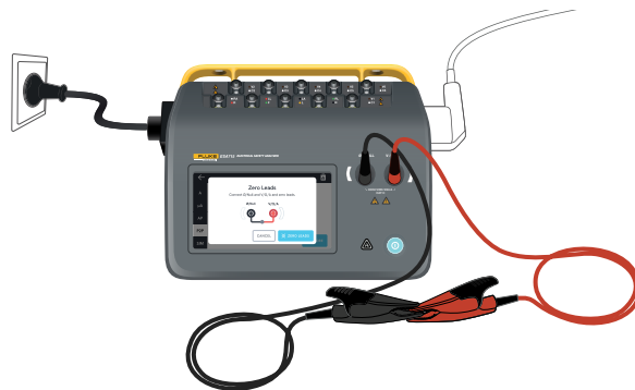
Figura 10: Configuración para la puesta a cero en mediciones de resistencia punto a punto, utilizando dos conductores de prueba.
