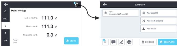
**Figura 12:** Come completare o annullare una sessione di misurazione.
