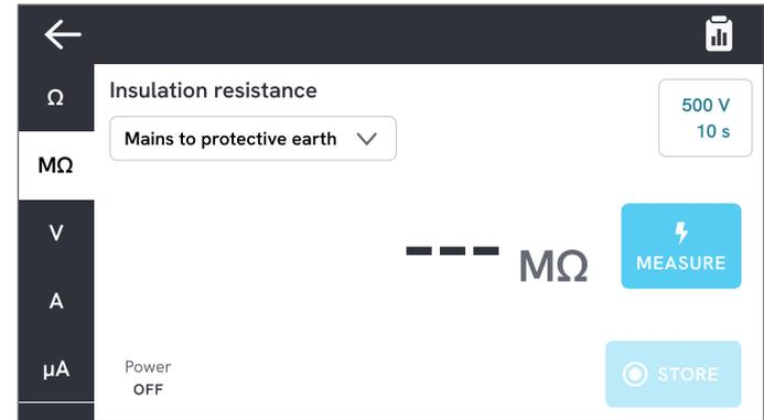
**Figura 19:** Misurazione della resistenza di isolamento
