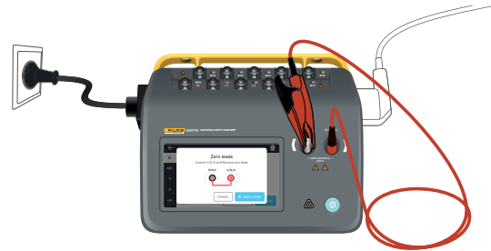
Abbildung 9: Einrichtung für den Nullabgleich bei Messungen des Schutzerdungswiderstands mit einer Messleitung und dem Nullklemmenadapter.
