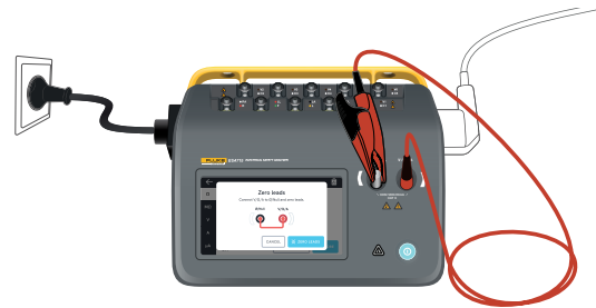
Figure 9 : Configuration pour la mise à zéro des mesures de la résistance de la terre de protection, en utilisant un cordon de mesure et l'adaptateur de prise nul.
