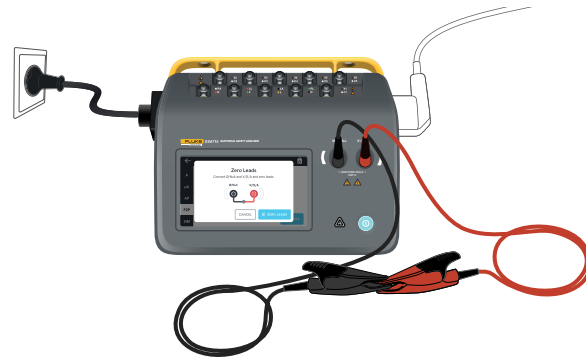
Figure 10 : Configuration pour la mise à zéro lors de mesures de résistance point à point, en utilisant deux cordons de mesure.
