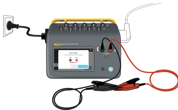
Figura 10: Impostazione per l'azzeramento nelle misurazioni della resistenza punto a punto, utilizzando due puntali di test.
