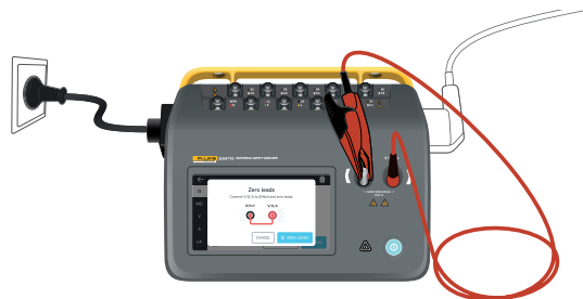
Figura 9: Impostazione per l'azzeramento delle misurazioni della resistenza della terra di protezione, utilizzando un puntale e l'adattatore del terminale null.
