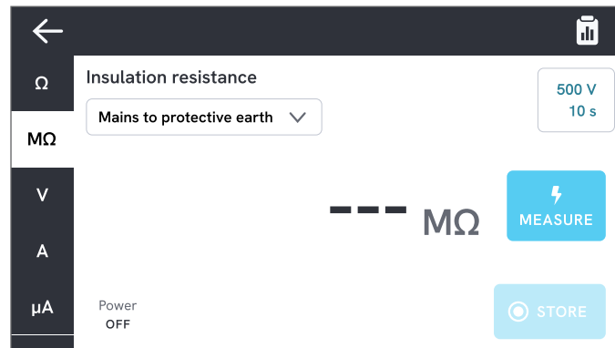
Figura 18: Misurazione della resistenza di isolamento
