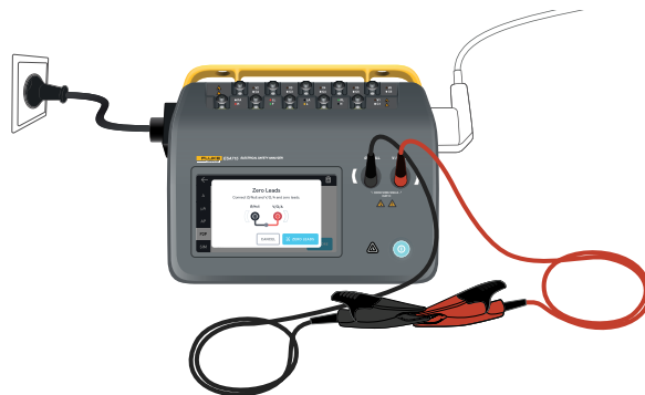
図10: テスト・リード2本を使用した、2点間抵抗測定におけるゼロ点調整の設定。
