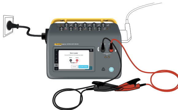
Rysunek 10: Konfiguracja zerowania przy pomiarach rezystancji punkt-punkt za pomocą dwóch przewodów pomiarowych.
