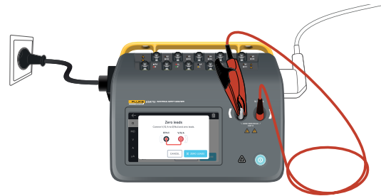
Figura 9: Configuração para zerar medições de resistência de aterramento de proteção, usando um terminal de teste e o adaptador de polo nulo.
